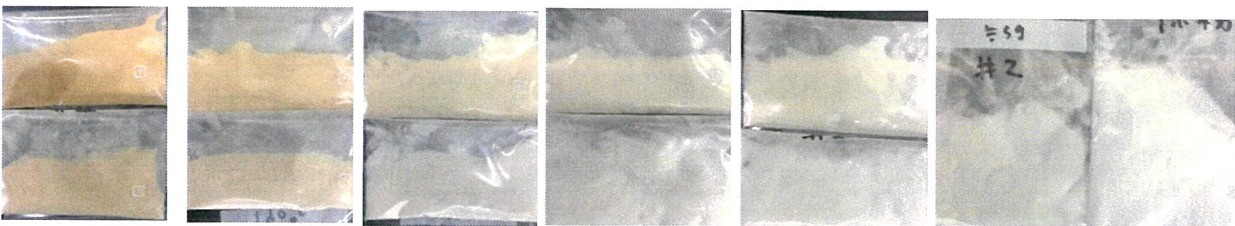
200°C 190°C 180°C 170°C 160°C 155°C 原粉 乾燥室内部写真 ③~⑤測定位置 2時間 変色有り
