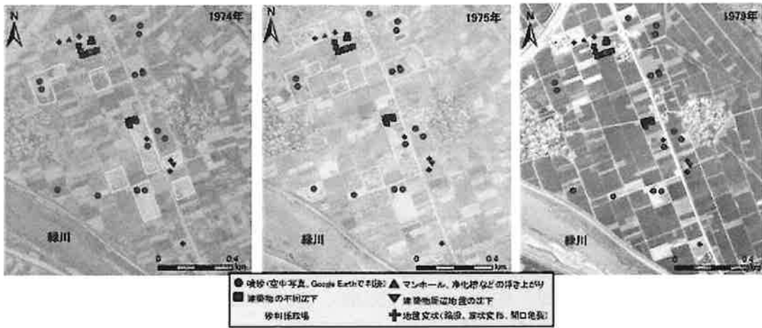
図30 緑川中流域における1970年代の砂利採取場分布と本地震液状化発生地点との関係（国土地理院撮影空中写真 MKU742X-C11-9、CKU7422-C58-23、KU794X-C2-10 から抜粋）
