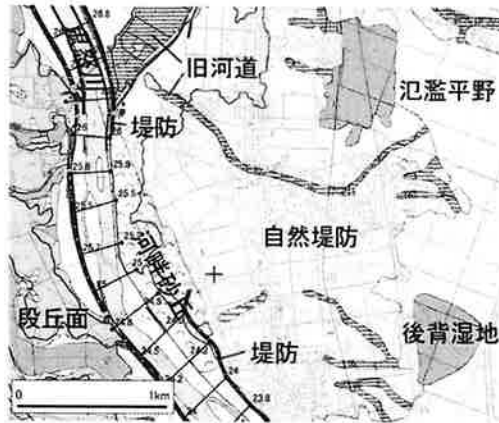
図2 常総市若宮戸地区周辺の地形と河川堤防の分布 (国土地理院治水地形分類図更新版を用いた)
