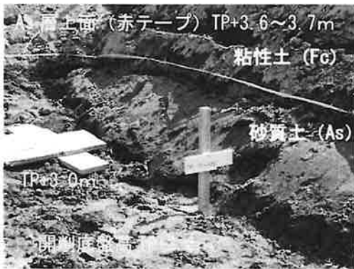
写真7 砂層(As層)と粘性土の状況
