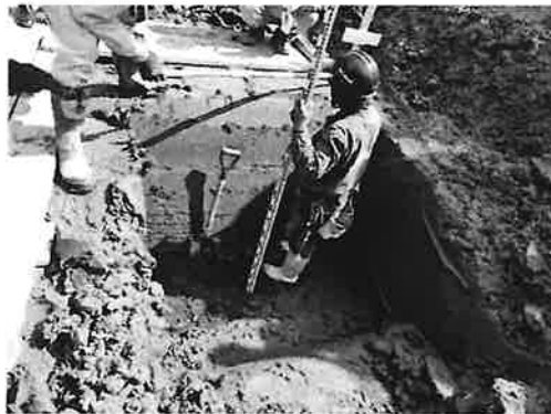
写真 17 Ac層厚の確認
