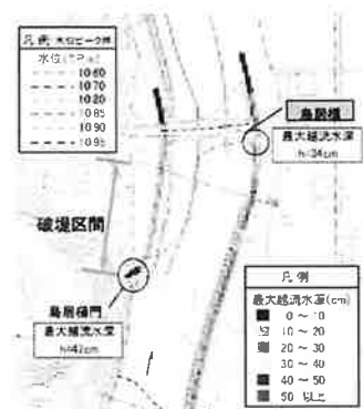
図-4.2.11 破堤地点周辺の流況
