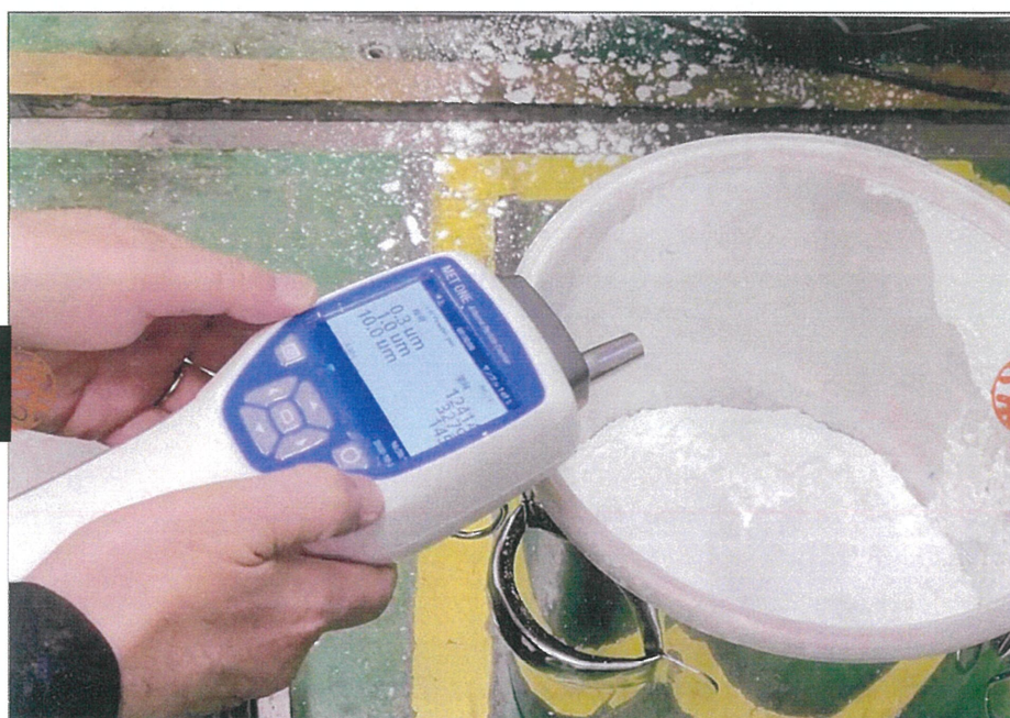
粉体回収時のポット周辺をパーティクルカウンターで測定したところを撮影。
