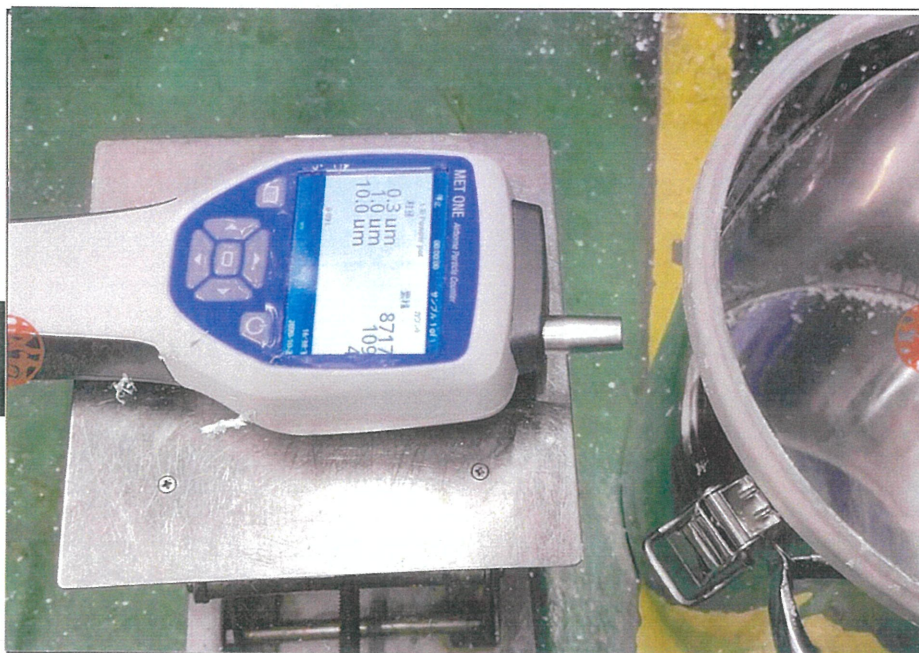
粉体回収前に、空になったポット周辺をパーティクルカウンターで測定したところを撮影。
