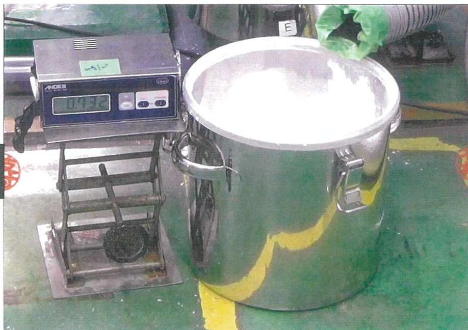
粉体回収時のポット周辺を粉じんモニターで測定したところを撮影。
