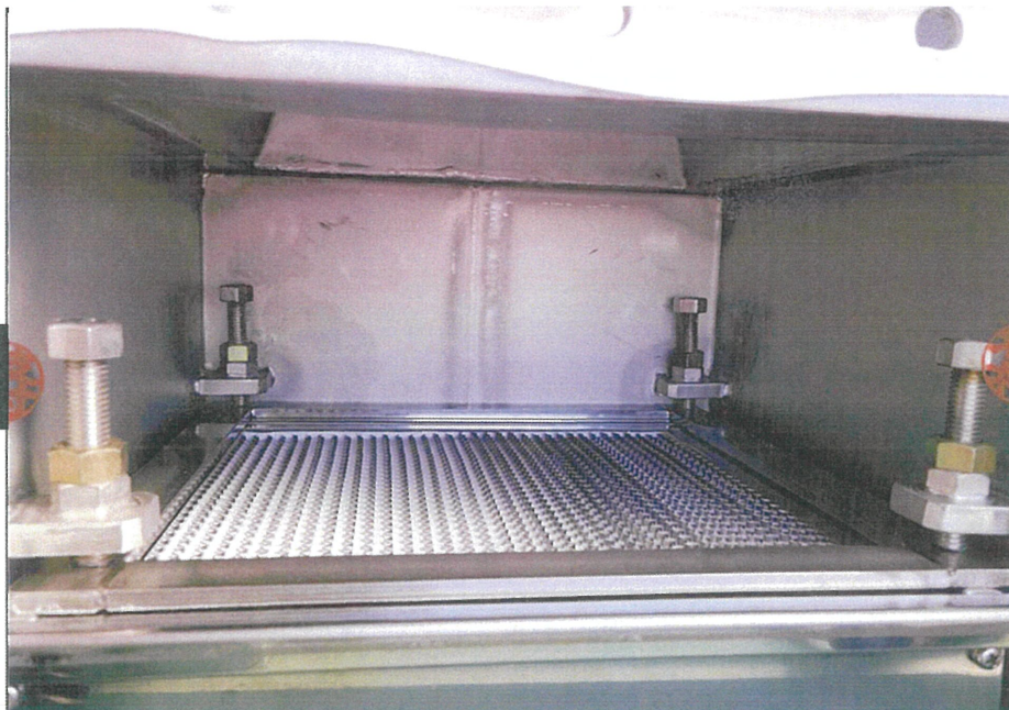
HEPAフィルター部内部・上面を撮影。バグフィルタ上部から送られた空気が写真上部の穴を通り、HEPAフィルターを透過する構造になっている。
