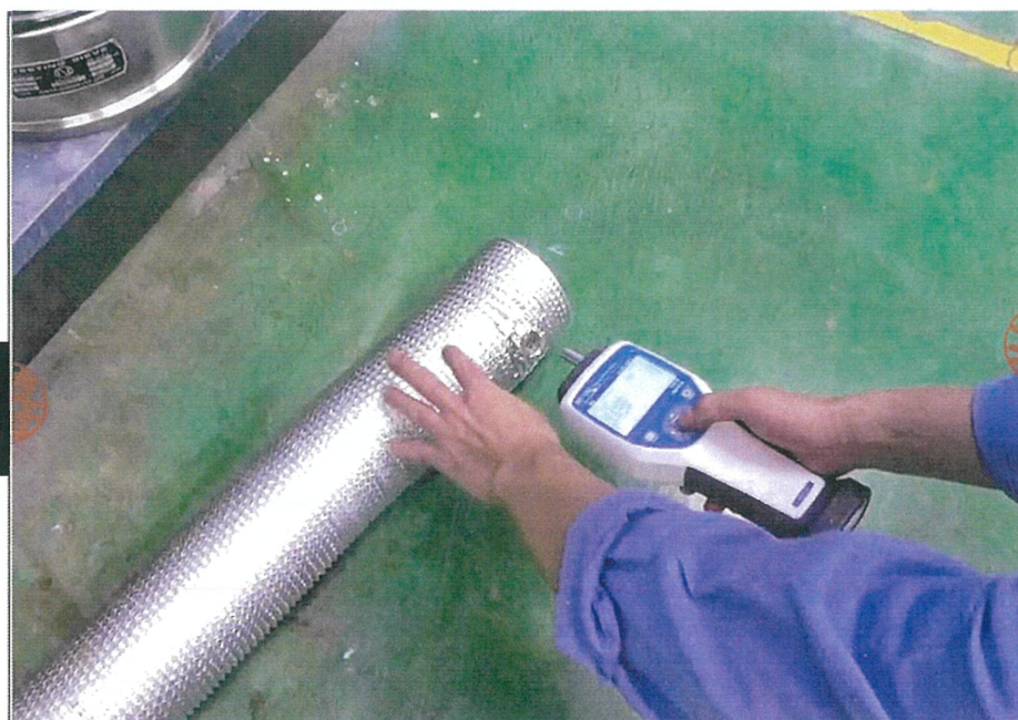
測定用吸引チューブ出口にパーティクルカウンターを取り付ける様子を撮影。
