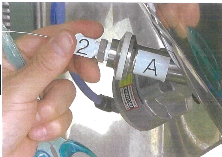
乾燥室測定口に極細型熱電対を挿入し、同測定口を閉じた状態を撮影。
