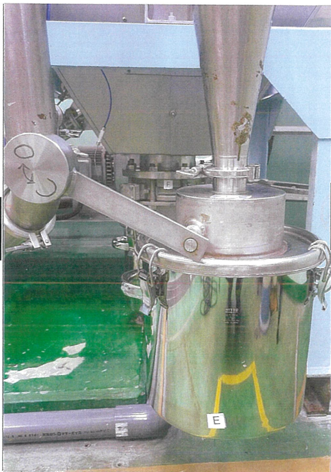
サイクロン下部およびサイクロンポットを撮影。
