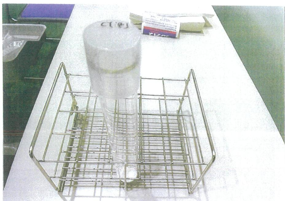
サイクロン入口測定口（粉体採取箇所 B）から採取した粉体の様子を撮影
