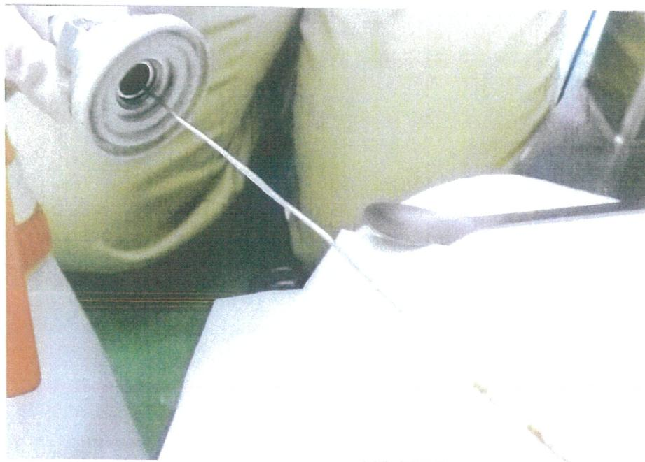
乾熱運転後の乾燥室測定口（粉体採取箇所A）に挿入されていた条件確認用極細型
