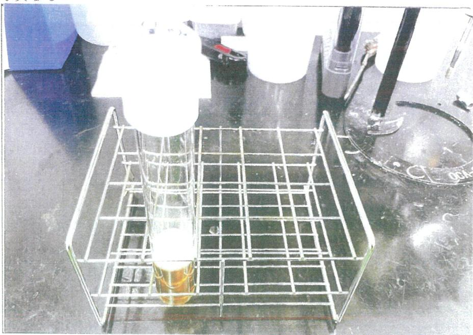
サイクロン測定口（粉体採取箇所B）の粉体を液体培地に溶解したものを撮影
