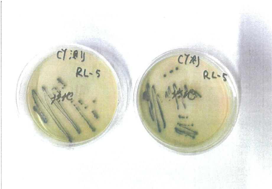
サイクロン測定口（粉体採取箇所B）から採取した粉体の溶解液を塗布した寒天培地上に青色の集落が形成された様子を撮影（青色は大腸菌の集落を示す）
