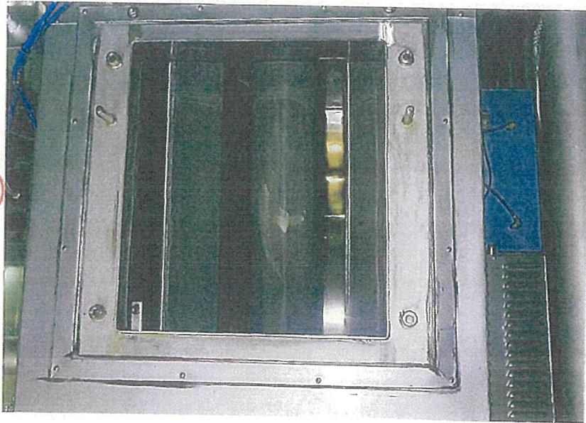
バグフィルタ内に取り付けてある、ろ布の状況を撮影 ろ布表面に付着している灰色粉体は、株式会社 [redacted] の製品
