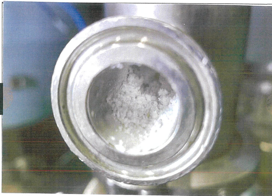
乾熱運転直後のサイクロン入口測定口（測定箇所B）を撮影。
