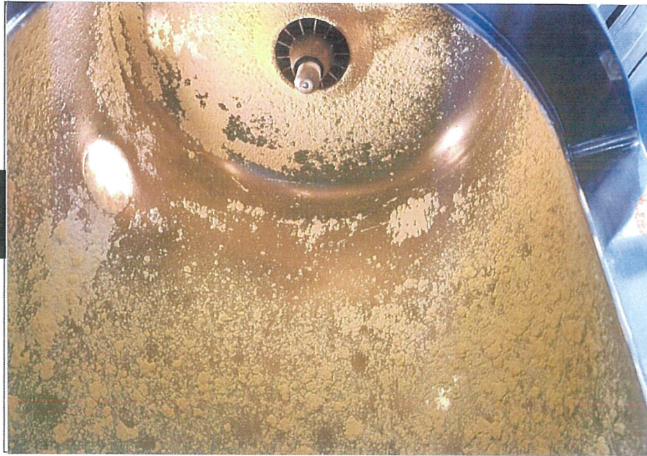
乾熱運転直後の乾燥室上部を撮影。
