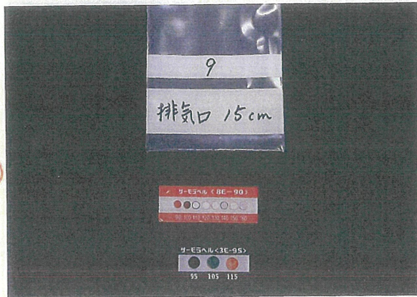
運転を停止させた後、温度測定箇所⑨の「排気口15cm（装置末端の排風機後の管）」から取り外した2種類のサーモラベルを撮影した状況。
