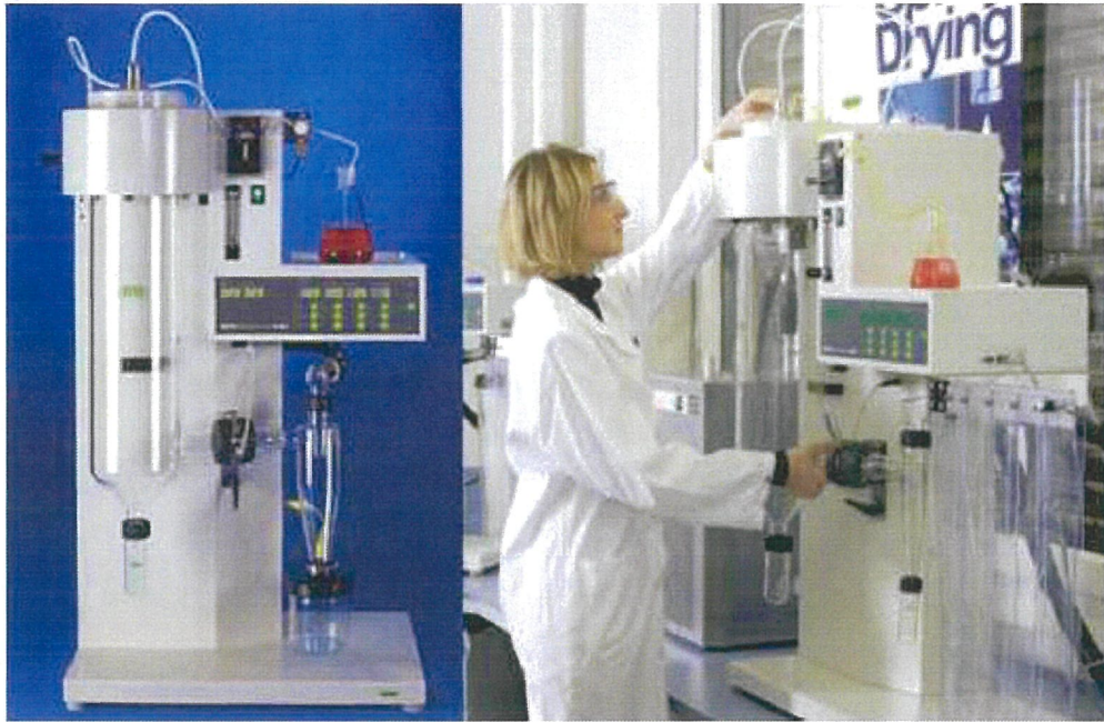
図1. 5-4 蒸発容量1K g/時の噴霧乾燥器の例 (オーストラリアグループ、Common Control List Handbook Vol.-IIより)
