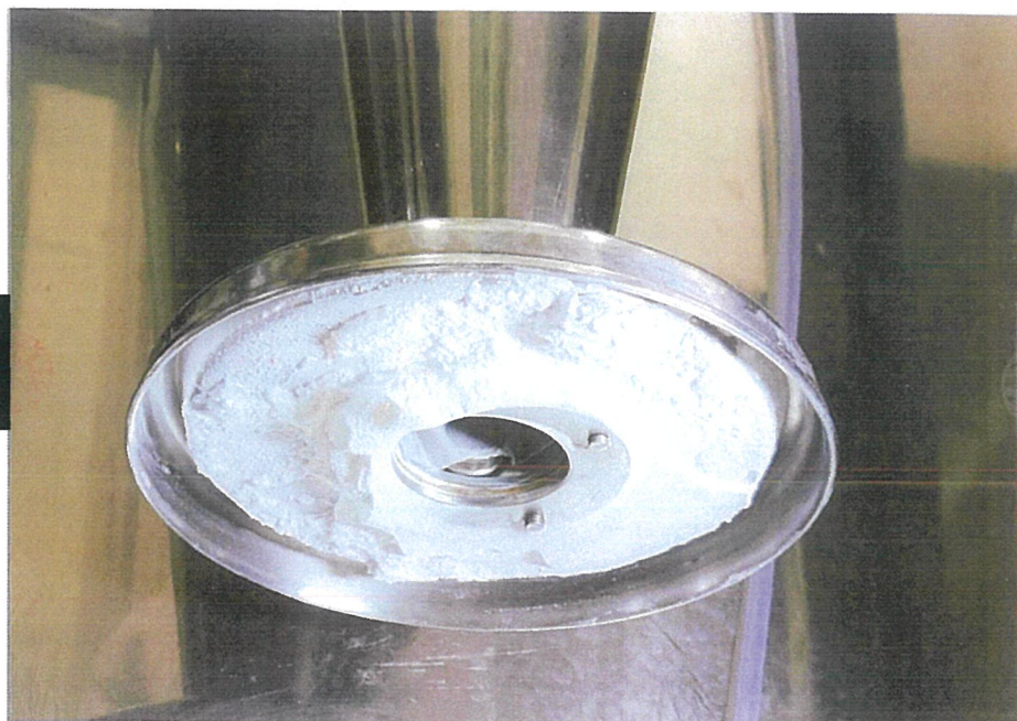
乾熱運転直後のサイクロン下部（裏側）を撮影。写真中央が測定箇所Cである。
