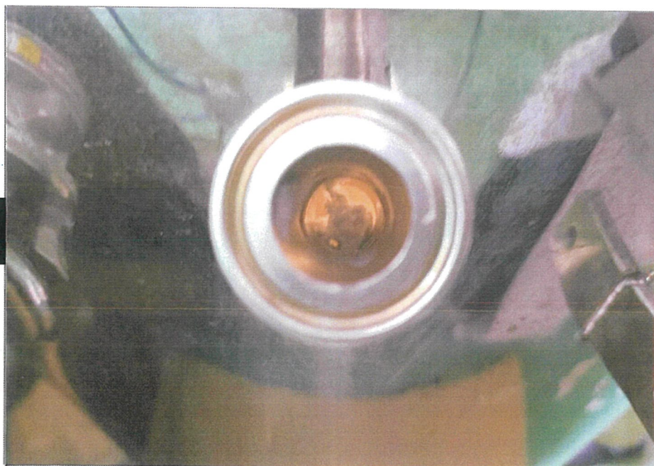
乾熱運転直後の乾燥室測定口（測定箇所A）を装置外側から撮影。
