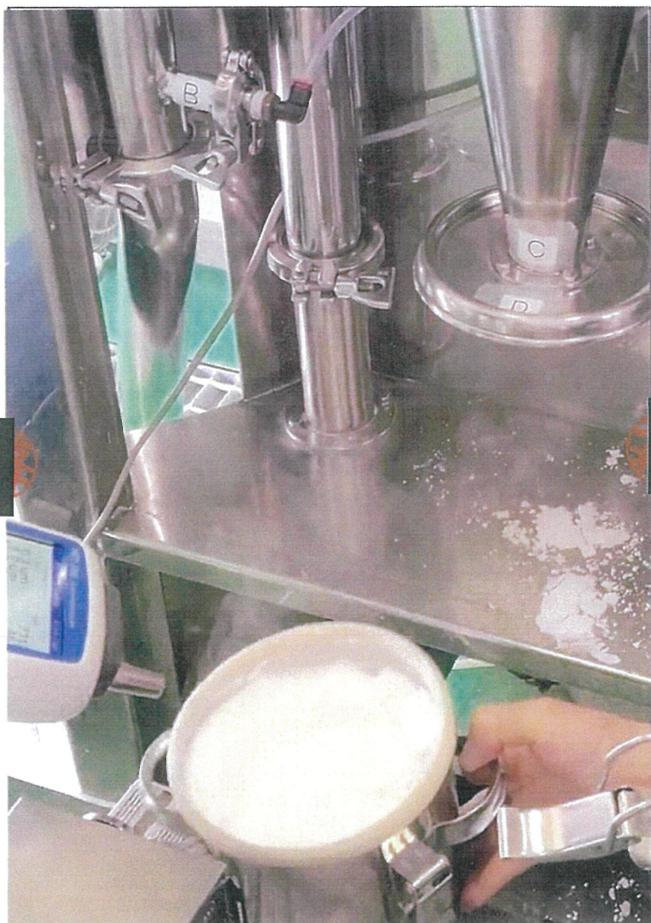
粉体回収時のポットの様子を撮影。写真中央の白煙は、噴霧乾燥によって得られたデキストリンの乾燥粉体である。
