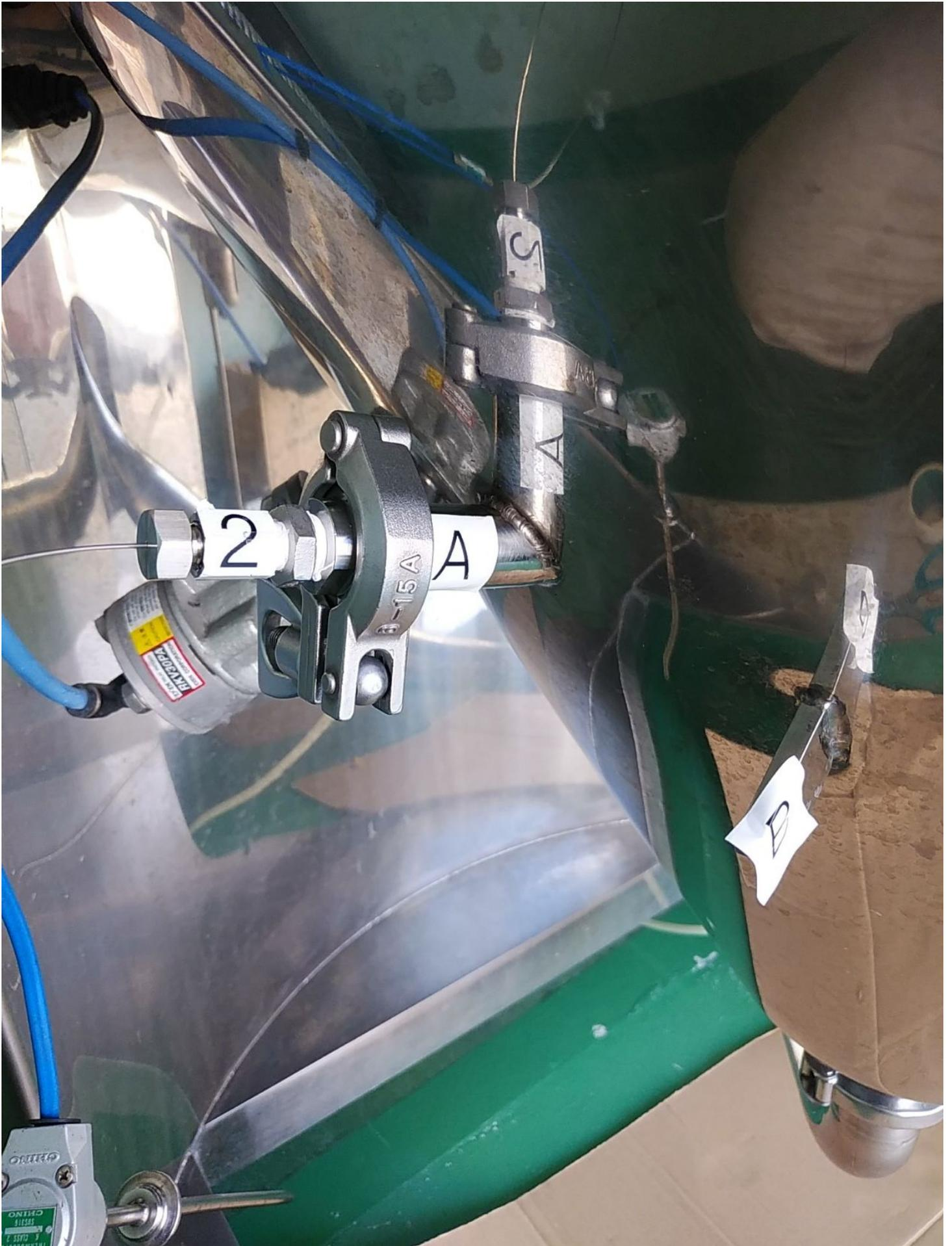
内部温度や内部圧力等を測定する計器（熱電対）を装着した本件噴霧乾燥器2の乾燥室測定口を、乾燥室外部から撮影したもの
