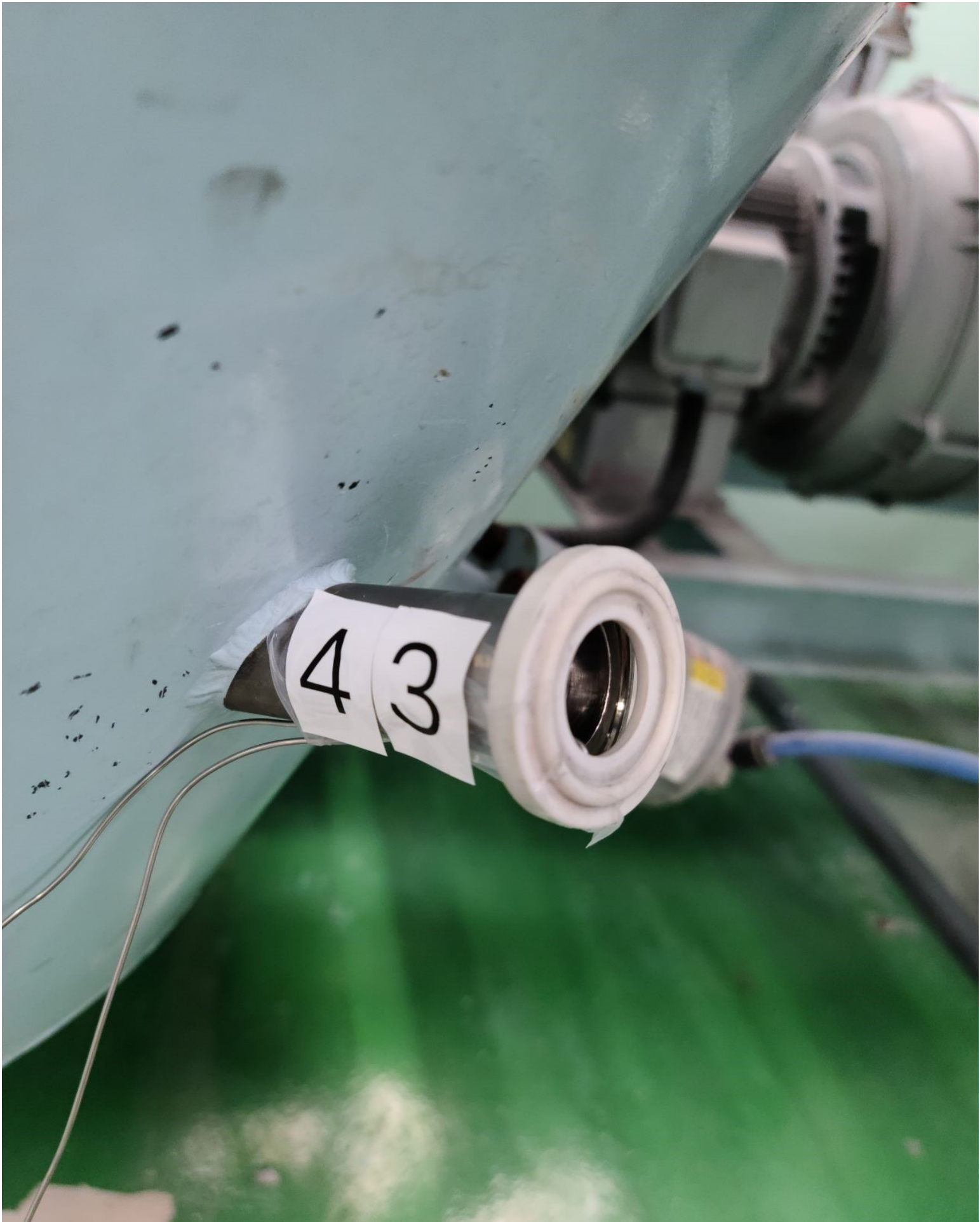
本件噴霧乾燥器 1 の乾燥室測定口を乾燥室外部から撮影したもの
