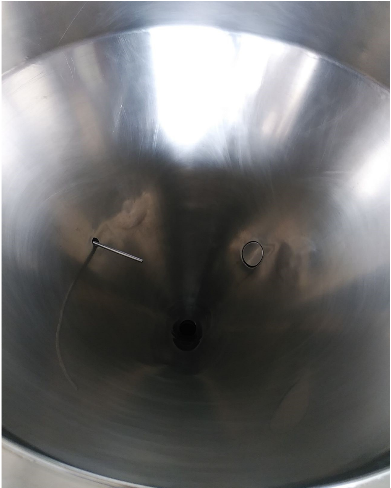
本件噴霧乾燥器 2 の乾燥室測定口を乾燥室内部から撮影したもの（乾燥室測定口は写真左）
