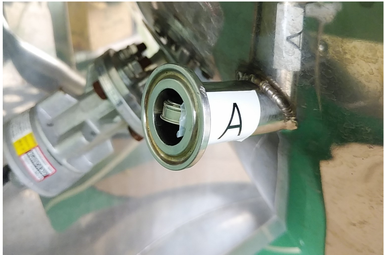
本件噴霧乾燥器2の乾燥室測定口を乾燥室外部から撮影したもの
