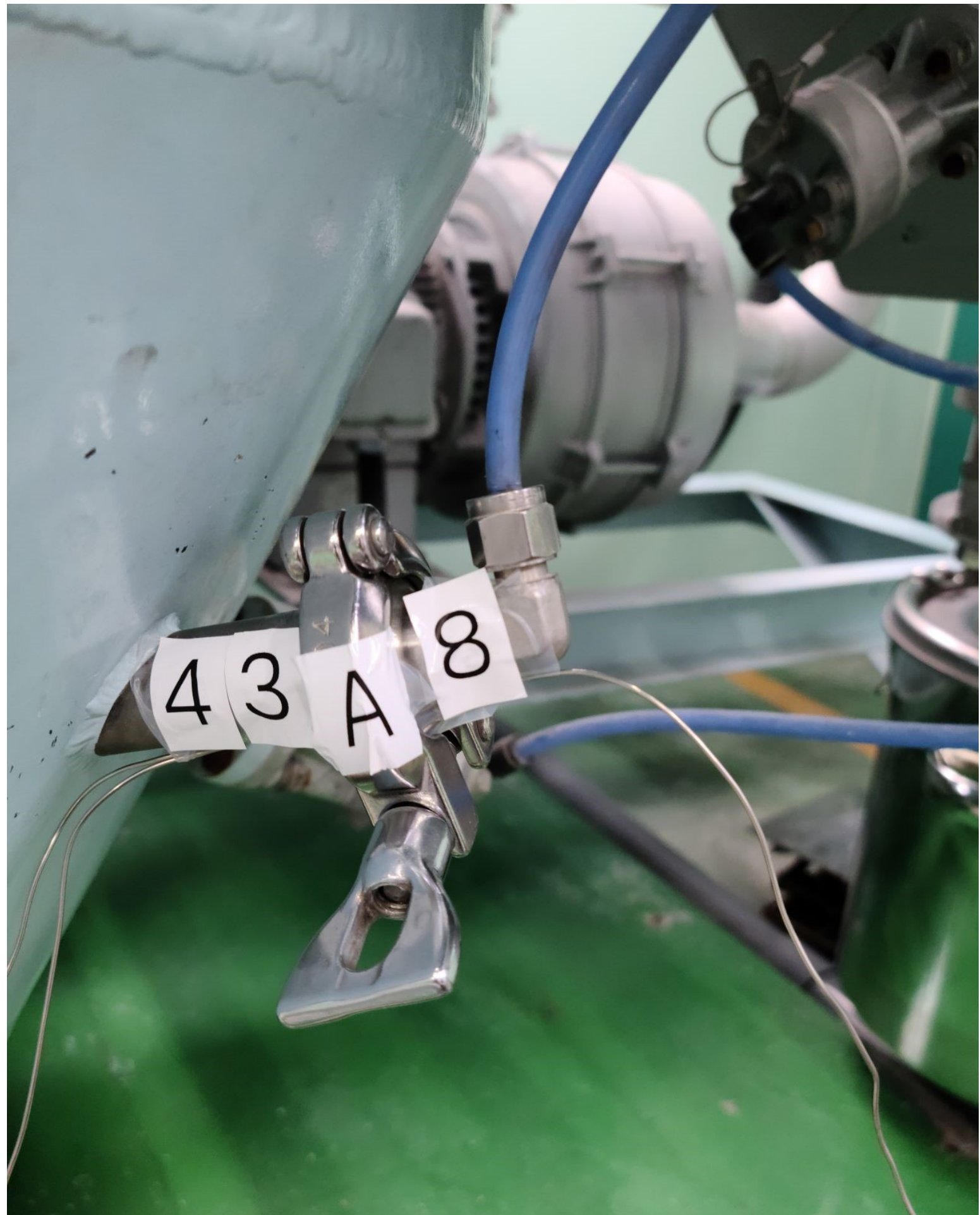
内部温度や内部圧力等を測定する計器（熱電対）を装着した本件噴霧乾燥器1の乾燥室測定口を、乾燥室外部から撮影したもの
