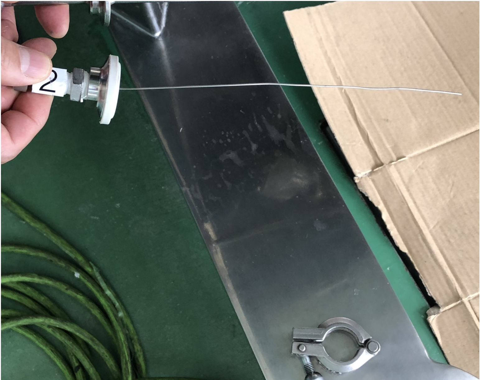
内部温度や内部圧力等を測定する計器（熱電対）を撮影したもの（熱電対は写真上部）
