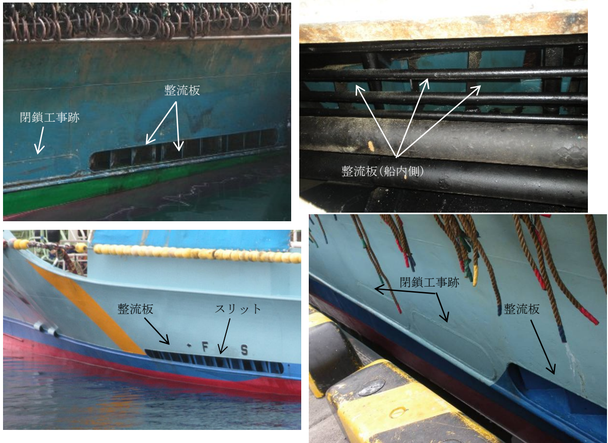
写真 2.5-2 類似船型の網船の放水口
